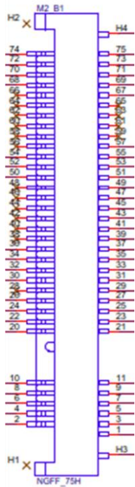
图 3-18 M.2 B-Key 接口示意图
