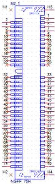
图 3-20 M.2 E-Key 接口示意图
