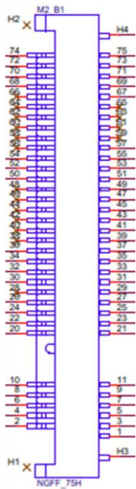
图 3-19 M.2 B-Key 示意图
