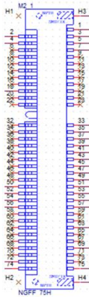
图3-20 M.2 E-Key接口示意图
